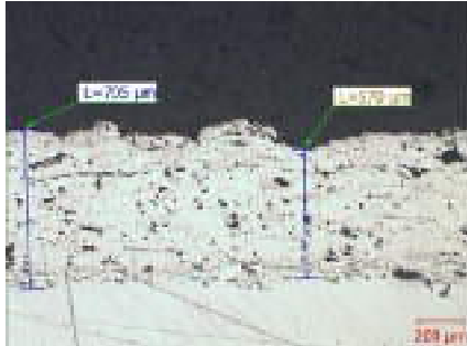
Рис. 1. Микршлиф покрытия PRHX15CP2
