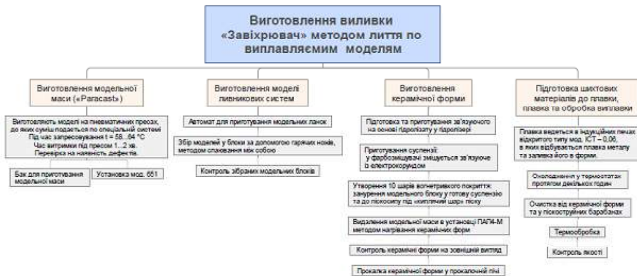
Рис. 1. Послідовність операцій для виготовлення вилвки «Завіхрювач» методом лиття по виплавляваним моделям
