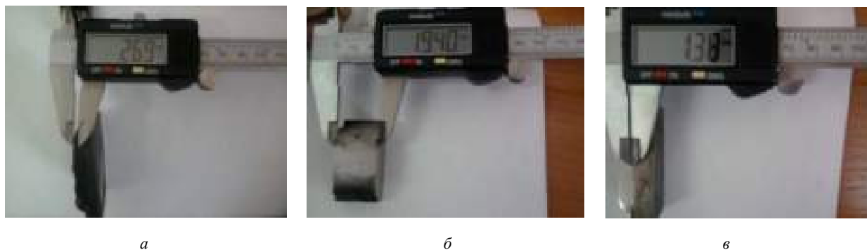
Рис. 2. Методика измерения высоты усиления (а), ширины шва (б), глубины проплавления (в)
