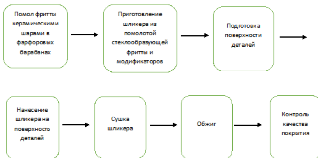
Рис. 1. Технологическая схема получения тугоплавкой эмали
