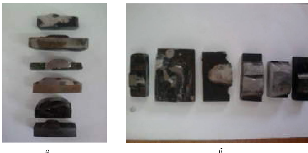
Рис. 1. Результаты наплавки экспериментальных образцов: а – в разрезе; б – вид сверху
