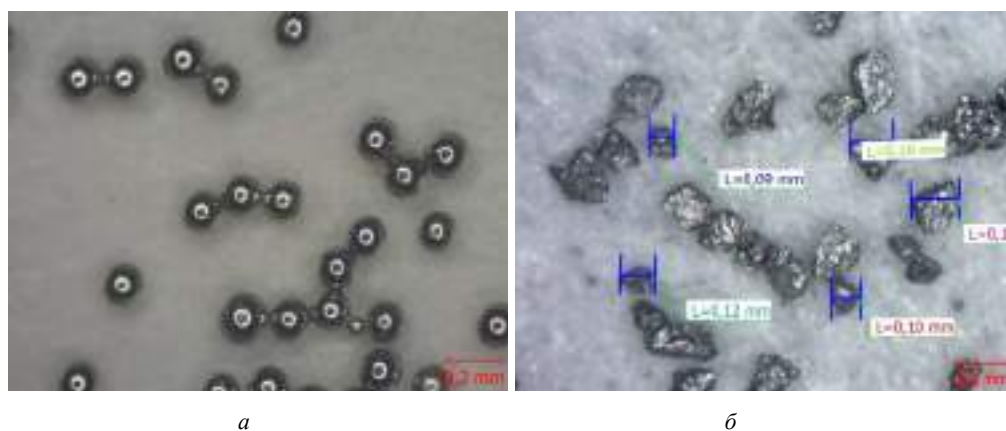
Рис. 1. Внешний вид порошковых материалов: а – сферических порошков, б – порошков несферической формы
