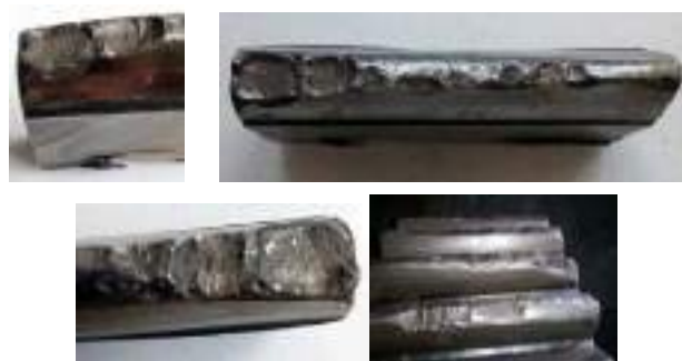
Рис. 2. Отработанные и сильно поврежденные фрагменты зубьев шестерен \times 1/2
