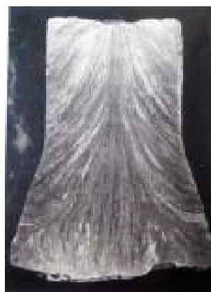
Рис. 2. Макроструктура заготовки запорного клапана из стали 08X18H10T, полученного методом ЭШВ + ДП
