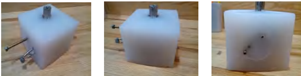
Рис. 25–27. Силиконовые формы для изготовления восковых моделей для метода литья по выплавляемым моделям (ЛВМ)
