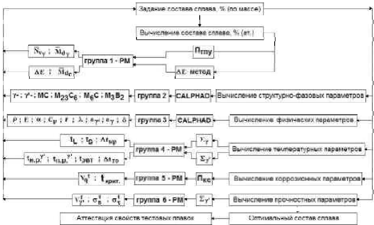
Рис. 1. Общий алгоритм компьютерного расчета разработанной методики КРАМ для проектирования литейных ЖНС с требуемым уровнем служебных характеристик
