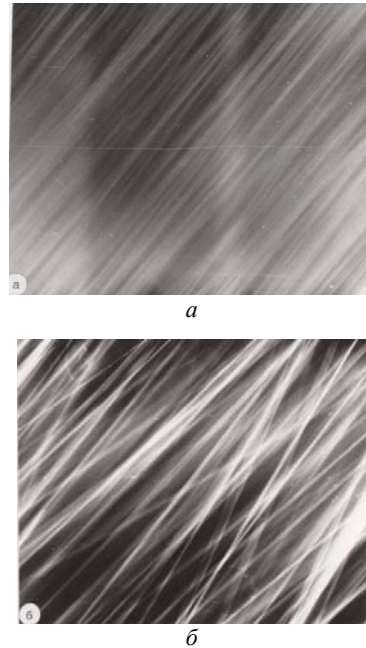
Рисунок 5. Фотографії треків частинок алюмінію, що світяться, у плазмовому струмені: а – у результаті дроблення, б – за відсутності дроблення
