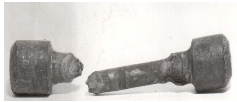
Рисунок 1. Зовнішній вигляд зразків із сплаву ВЖЛ-12У після випробувань в синтетичній золі, час до руйнування 740 годин
