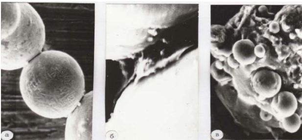
Рисунок 4. Дроблення часток алюмінію в плазмовій струміні: а – ділення розплавленої частинки, б – здування розплаву з поверхні частинки, в – утворення на поверхні подрібнених частинок
