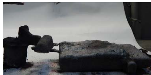
Рисунок 10. Виливок «Вертикальна плита» із чавуна, виготовлений у формі без добавок
