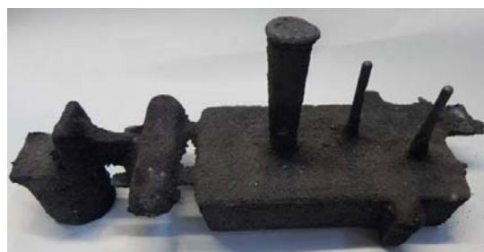
Рисунок 11. Виливок «Вертикальна плита» із чавуна, виготовлений у формі з добавкою 1,0 % ТПФН
