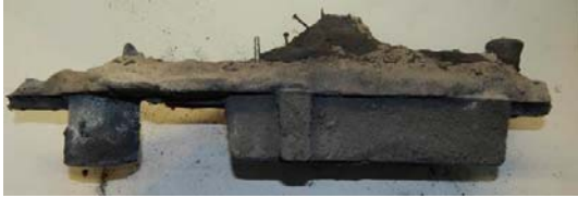
Рисунок 12. Виливок, виготовлений із застосуванням верхньої півформи з рідким склом
