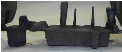
Рисунок 13. Виливок, виготовлений у формі з добавкою 0,5 % ГМФН
