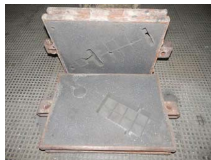
Рисунок 9. Форма для заливання чавуном
