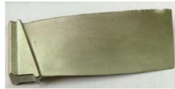
Рисунок 1. Лопатка I-го ступеня дв. ТВ3-117 із пошкодженнями пера
