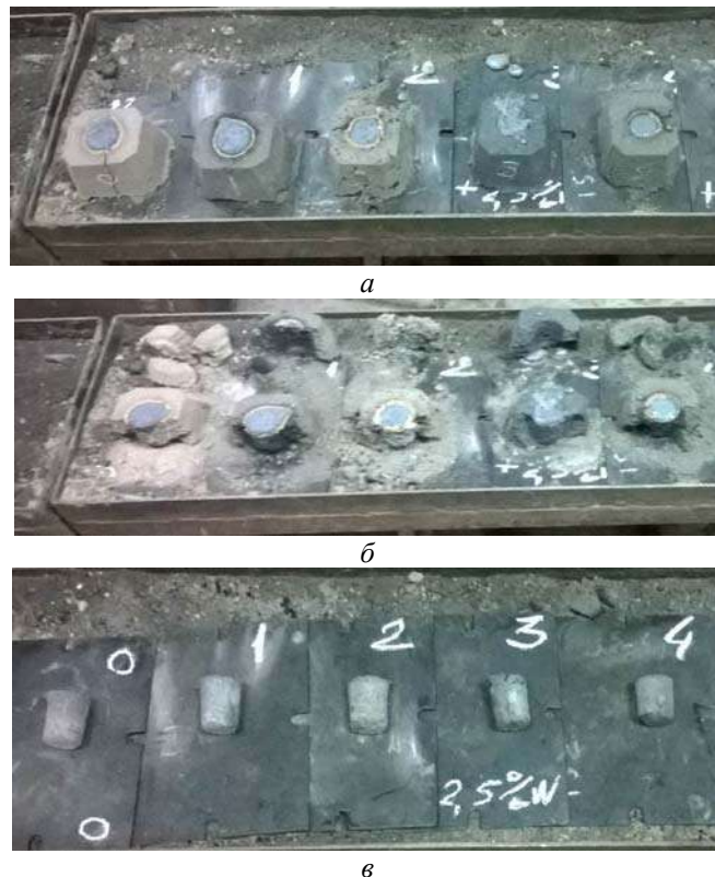
Рис. 2. Зовнішній вигляд зразків чавуну залитих у воگی піщано-бентонітові форми: a – залиті ливарні форми; б – зразки чавуну після руйнування ливарної форми; в – зовнішній вигляд зразків чавуну після очищення в барабані; 0 – без додавання протипригарних добавок; 1 – додавання 5 % павлоградського вугілля; 2 – додавання 5 % донецького вугілля; 3 – додавання 5 % львівського вугілля; 4 – додавання 5 % «Контрасанд»
