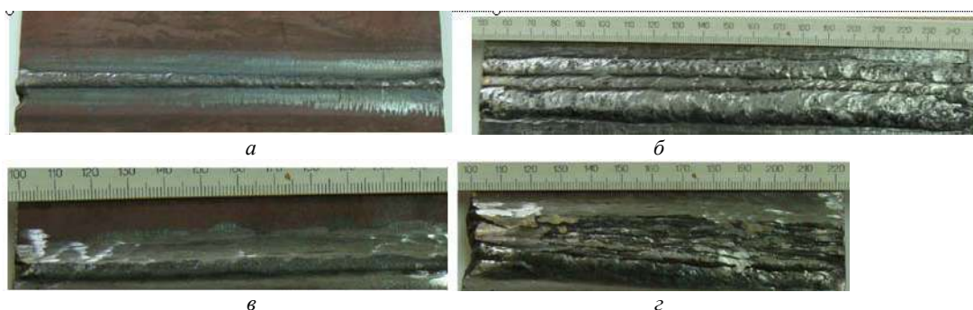
Рис. 3. Формування зварного шва при застосуванні імпульсної подачі; позиція 1G: а – кореневого шва на керамічній підкладці; б – лицювального шва; позиція 2G: в – кореневого шва на керамічній підкладці г – облицювального шва
