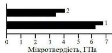
Рис. 3. Мікротвердість мартенситу відпуску сталей у колісах екструдерів після експлуатації:
