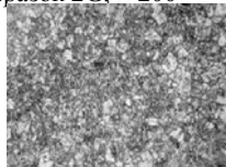
Рис. 17. Мікроструктура ділянки дрібного зерна 3ТВ, зразок 2G, \times 200
