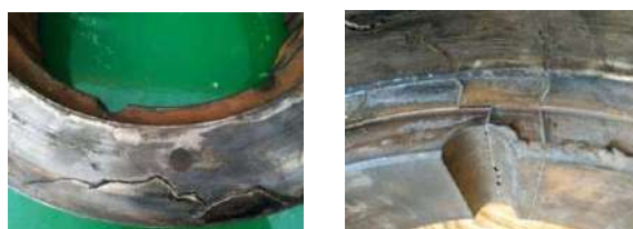
Рис. 6. Частина деталі-екструдера (дефекти) кованої сталі 4X5MФ1С після експлуатації
