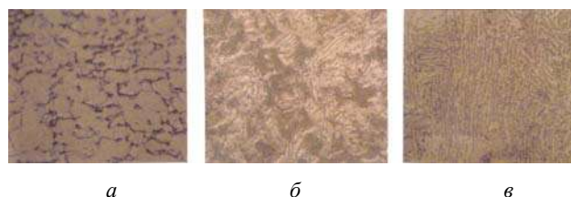
Рис. 8. Мікроструктура в сеченні пера лопатки в зонах а, б, та в (см. рис. 7)
