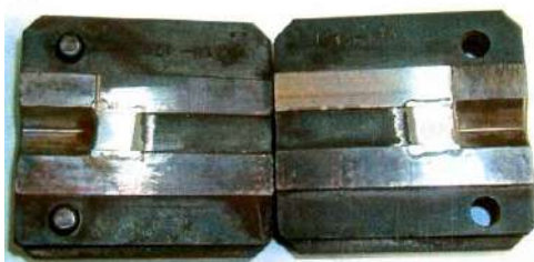
Рис. 1. Метод и оборудование для горячего выдавливания заготовок рабочих лопаток:
