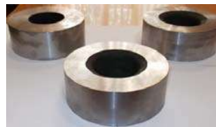
Рис. 2. Заготовки (сталь 4ХЗН5МЗФ), одержані після термічної обробки (відпал 750±20 °С) та механічної обробки
