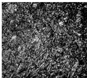
Рис. 1. Микроструктура стали 30ХГСА после изотермической закалки из МКИТ: нагрев на 790 °С, выдержка 30 мин, охлаждение до 300 °С, выдержка 60 мин, охлаждение на воздухе, ×500
