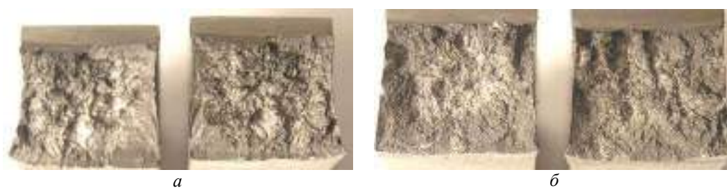
Рис. 6. Строение изломов термообработанных по стандартному режиму образцов из сплава ЖСЗДК-ВИ \times 2,5 : а – без присадки Ti(C,N); б – модифицирование Ti(C,N) в брикетах
