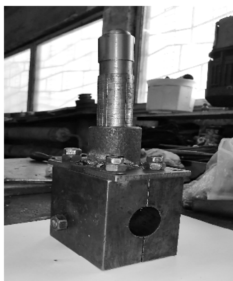
Рис. 5. Трубна заготовка з нанесеною сіткою
