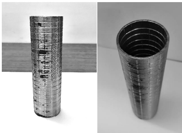
Рис. 5. Трубна заготовка з нанесеною сіткою
