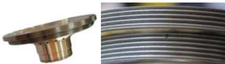
Рис. 1. Покрывающий диск турбины ГТД семейства ТВ3-117: a – общий вид; б – гребешки лабиринтного уплотнения
