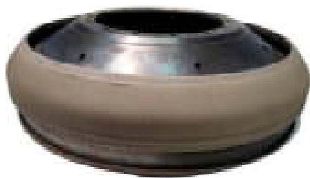
Рис. 1. Внешний вид корпуса внутреннего СА с покрытием ТЗП-2 без ТО
