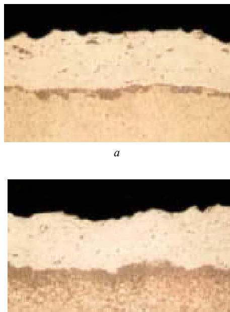
Рис. 4. Шлифы покрытия ПКХН-15 ( \times 200 ): а – покрытие КХН-15 до ТО; б – покрытие КХН-15 после ТО 810 °С
