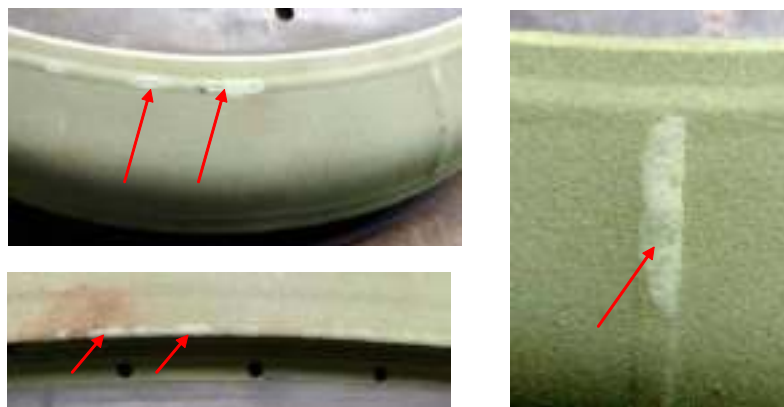
Рис. 8. Сколы покрытия ТЗП-2 после 50 циклов термоциклирования
