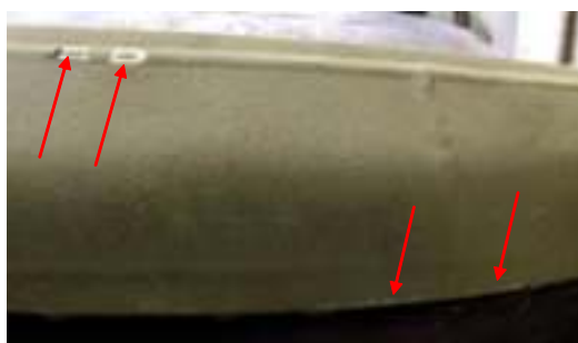
Рис. 6. Скол покрытия ТЗП-2 после 20 циклов термоциклирования
