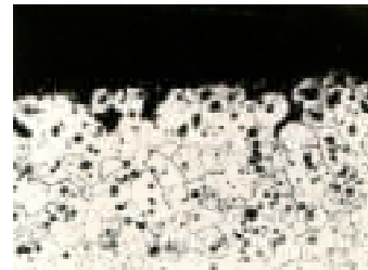
Рис. 4. Мікроструктура сірого чавуну після дифузійного титанування в суміші з 7 % NH_4F , \times 150
