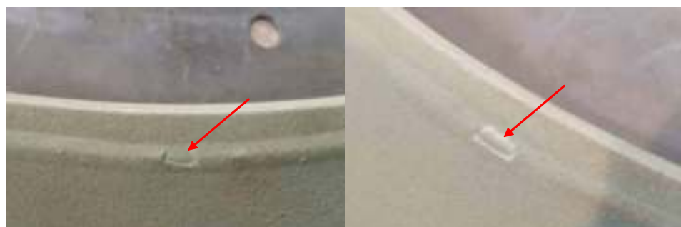
Рис. 5. Скол покрытия ТЗП-2 после 15 циклов термоциклирования
