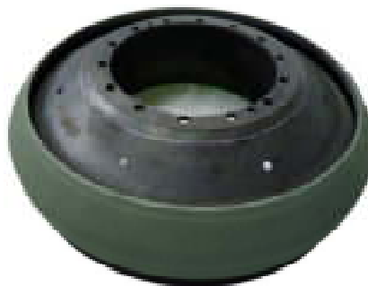
Рис. 2. Внешний вид покрытия ТЗП-2 после ТО
