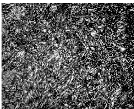
Рис. 1. Микроструктура стали 30ХГСА после изотермической закалки из МКИТ: нагрев на 790 °С, выдержка 30 мин, охлаждение до 300 °С, выдержка 60 мин, охлаждение на воздухе, \times 500
