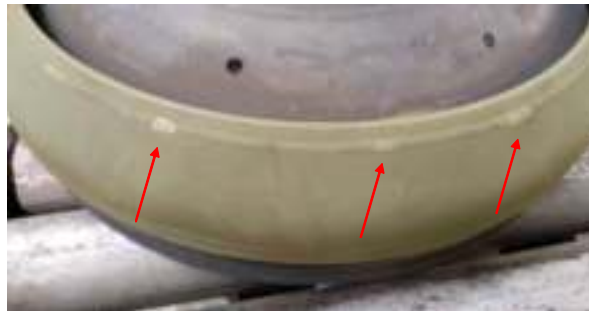
Рис. 7. Сколы покрытия ТЗП-2 после 35 циклов термоциклирования
