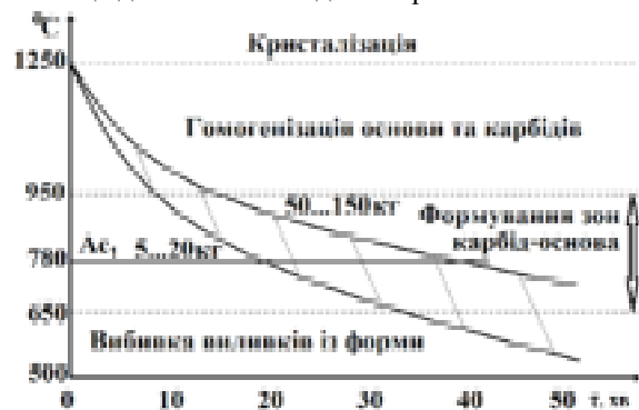
Рис. 3. Схеми процесів, що відбуваються під час охолодження виливків у формі від кристалізації до вибивки
