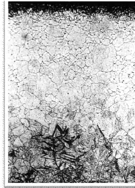
Рис. 1. Мікроструктура цементованої сталі 13Х3НВМ2Ф. Температура цементації та гарту 1030^\circ\text{C} , \times 300
