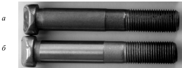
Рис. 1. Шатунні болти двигуна ЗМЗ-406 у вихідному стані (а) та після ІБ (б)
