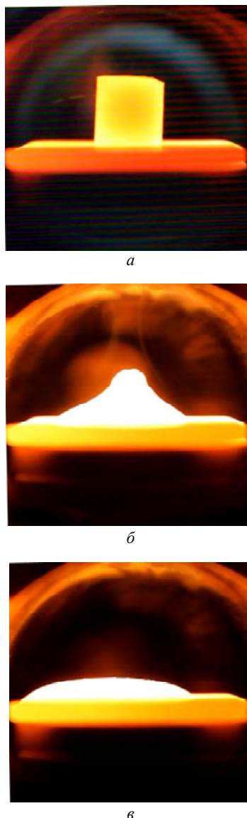
Рис. 3. Последовательность превращения образца в жидкую каплю: a – исходное состояние; b – растекание жидкой фазы; v – образование жидкой капли
