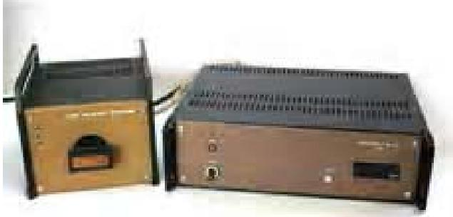
Рис. 10. Коэрцитиметр ВКС-968
