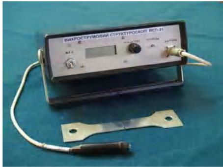
Рис. 3. Вихретоковий структуроскоп ВЕП-21
