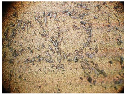
Рис. 2. Структура сплаву АК5М (АЛ15), \times 500 : а – заводська технологія; б – експериментальна
