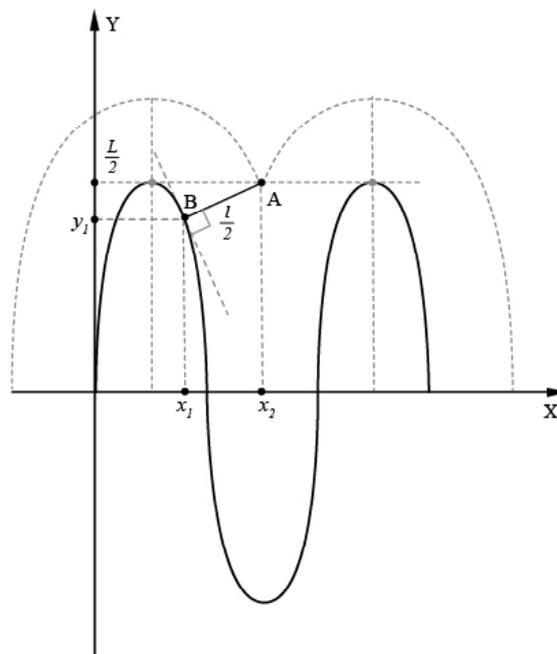
Рис. 2. К пояснению концепции сплошности при наплавке на неподвижную деталь сварочным инструментом с наложенными на него гармоническими колебаниями
