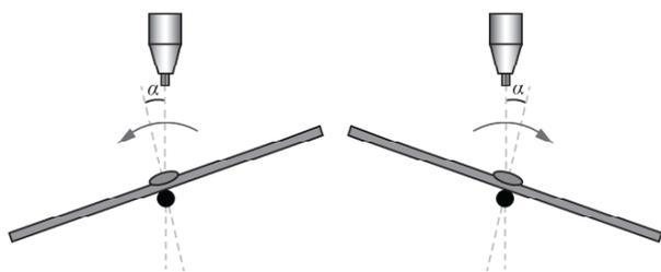
Рис. 1. Принципиальный вид подвижной станины
