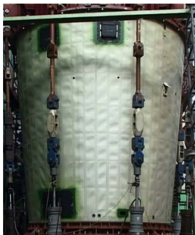
Рис. 7. Деформация обшивки на 5 этапе нагружения МСО 2-3 ступеней
