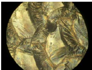
Рис. 6. Типова поверхня обробленого лазером зразка з тріщиною після перших циклів навантажень ( \times 500 )
