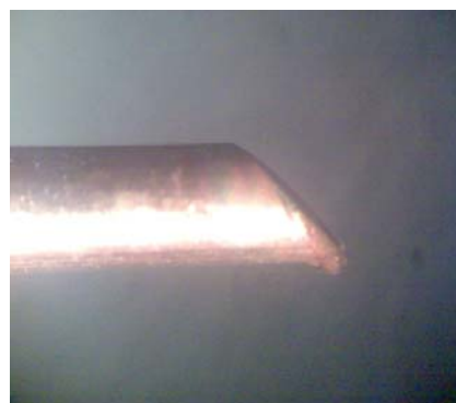
Рис. 1. Внешний вид оплавившегося торца проволоки марки М1
