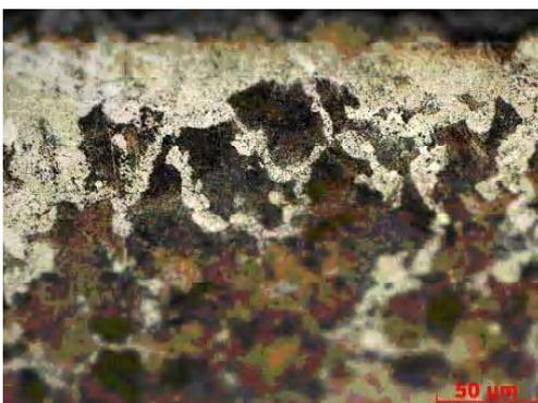
Рис. 7. Микроструктура силіцированої сталі ШЧ20СГ,  $\times 100$  и  $\times 500$
