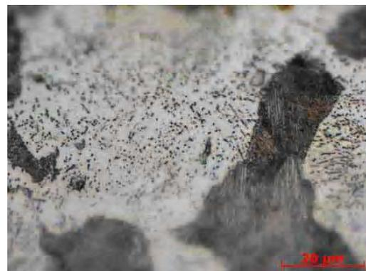
Рис. 5. Микроструктура силицированной стали ШХ15 × 500 и × 1250
