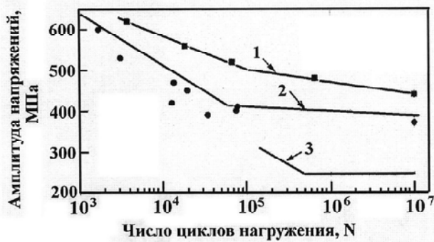
Рис. 14. Кривые многоциклового усталостного предела титана с различным размером зерна [33]:
