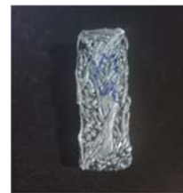
Рисунок 9. Нашарування пластика при перебільшеній екструзії
