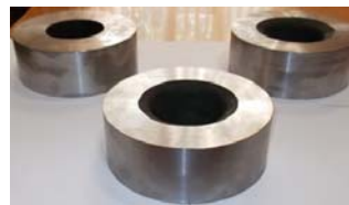
Рис. 2. Заготовки (сталь 4X3H5M3Ф), одержані після термічної обробки (відпал 750±20 °С) та механічної обробки
