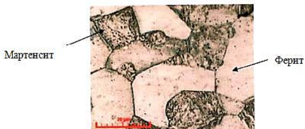
Рис. 1. Мікроструктура вихідних зразків сталі 06Х18ч (збільшення \times 1000 )
