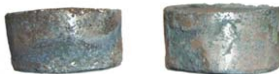
Рис. 5. Зразки синтезованого алюмініду титану в режимі теплового самоzapалювання
