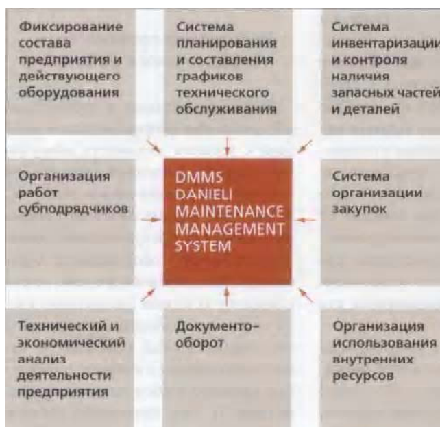
Рис. 9. Система технического обслуживания оборудования фирмы Danieli
