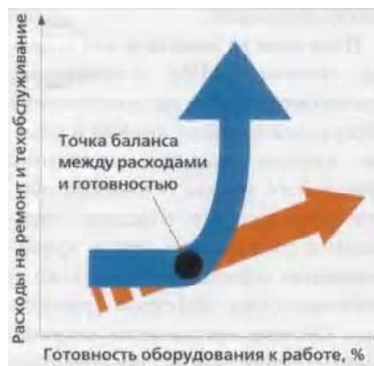
Рис. 10. Оптимизация планирования планово-предупредительных ремонтов
