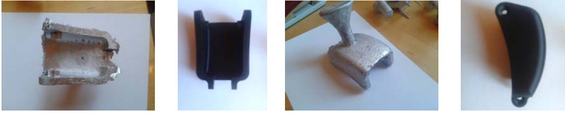
Рис. 15–18. Модель и отливка «Рычаг-2»
