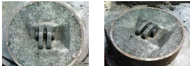
Рис. 23–24. Модель и разовая песчано-глинистая форма для детали «Колено»
