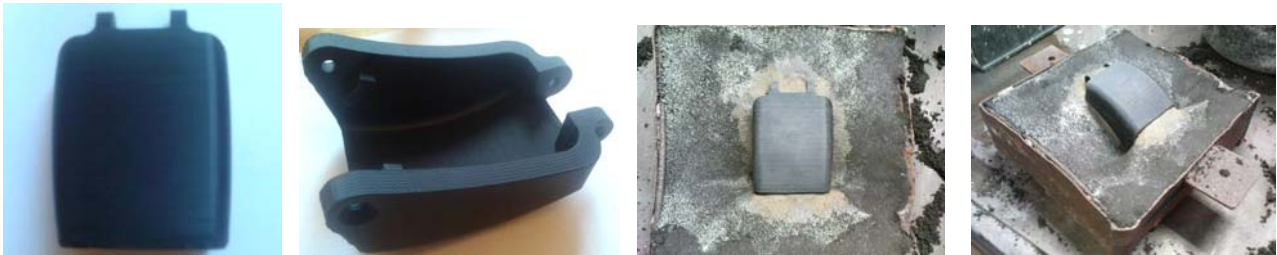
Рис. 19–22. Модель и разовая песчано-глинистая форма для детали «Рычаг-2»
