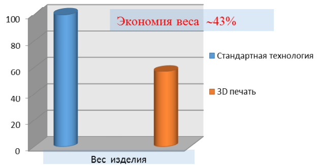
Рис. 8. Снижение веса изделия при использовании методов 3D печати
