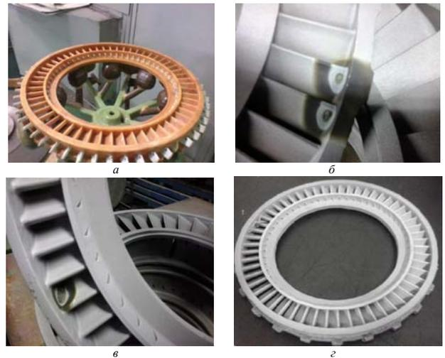
**Рис. 4.** Технологический процесс изготовления цельнолитого СА ТВ3-117 аппарата из спроектированного сплава ЖСЗЛС-М в условиях промышленного производства ЗМЗ им. В. И. Омеляченко: а – внешний вид модельного блока; б – устранение литейных точечных дефектов методом АДС; в – устранение микротрещин методом АДС; г – цельнолитой СА ТВ3-117 после устранения дефектов, ТО и ЛЮМ-контроля
